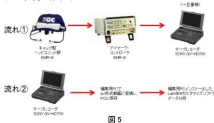
視野画像と視線データの同期されたデータを取得し、記録した(EMR-8セット、流れ①)。モニター枠を検出し、画像補正を経て、モニター内視線座標を取得した(流れ②の前半)。
